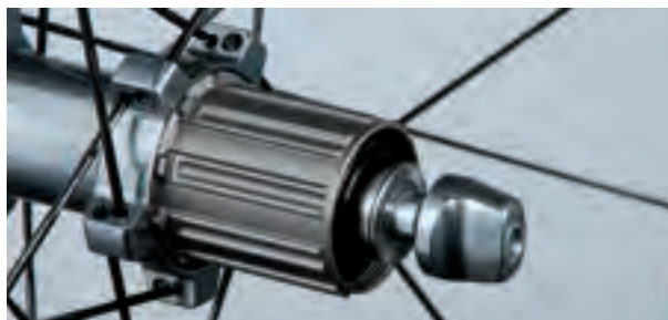
Vedação por labirinto e contato (estrada)
